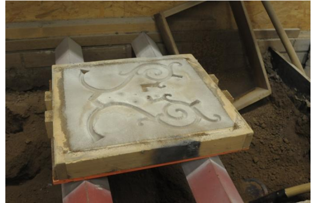
De afdruk van de gietmal in het zand.
