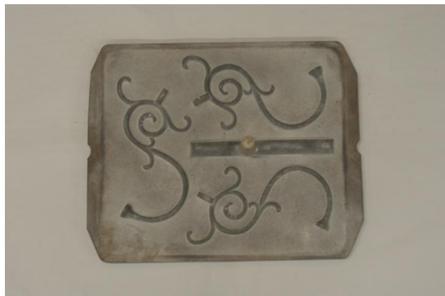
Gietmallen, het kostbaarste bezit van een geelgietersfamilie, werden doorgegeven werd aan de volgende generaties. Onder een moderne gietmal. Vroeger werd werden deze gietmallen uit hout gesneden.
