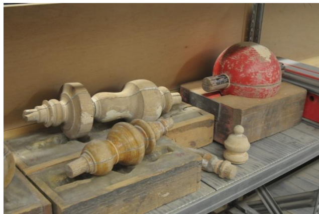
Gietmallen, het kostbaarste bezit van een geelgietersfamilie, werden doorgegeven werd aan de volgende generaties. Onder een moderne gietmal. Vroeger werd werden deze gietmallen uit hout gesneden.
