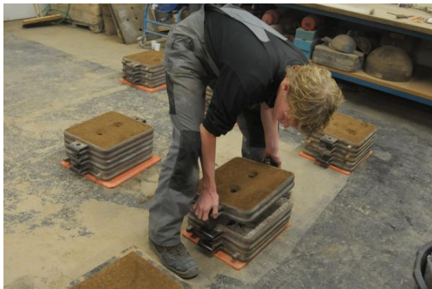
Het plaatsen van de onder- en bovenkasten op elkaar.
